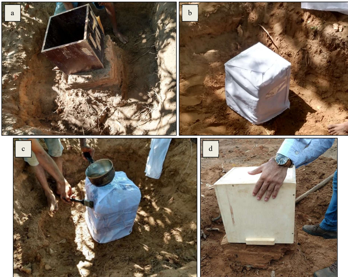
Figura 13. Processo de extração do solo indeformado.
