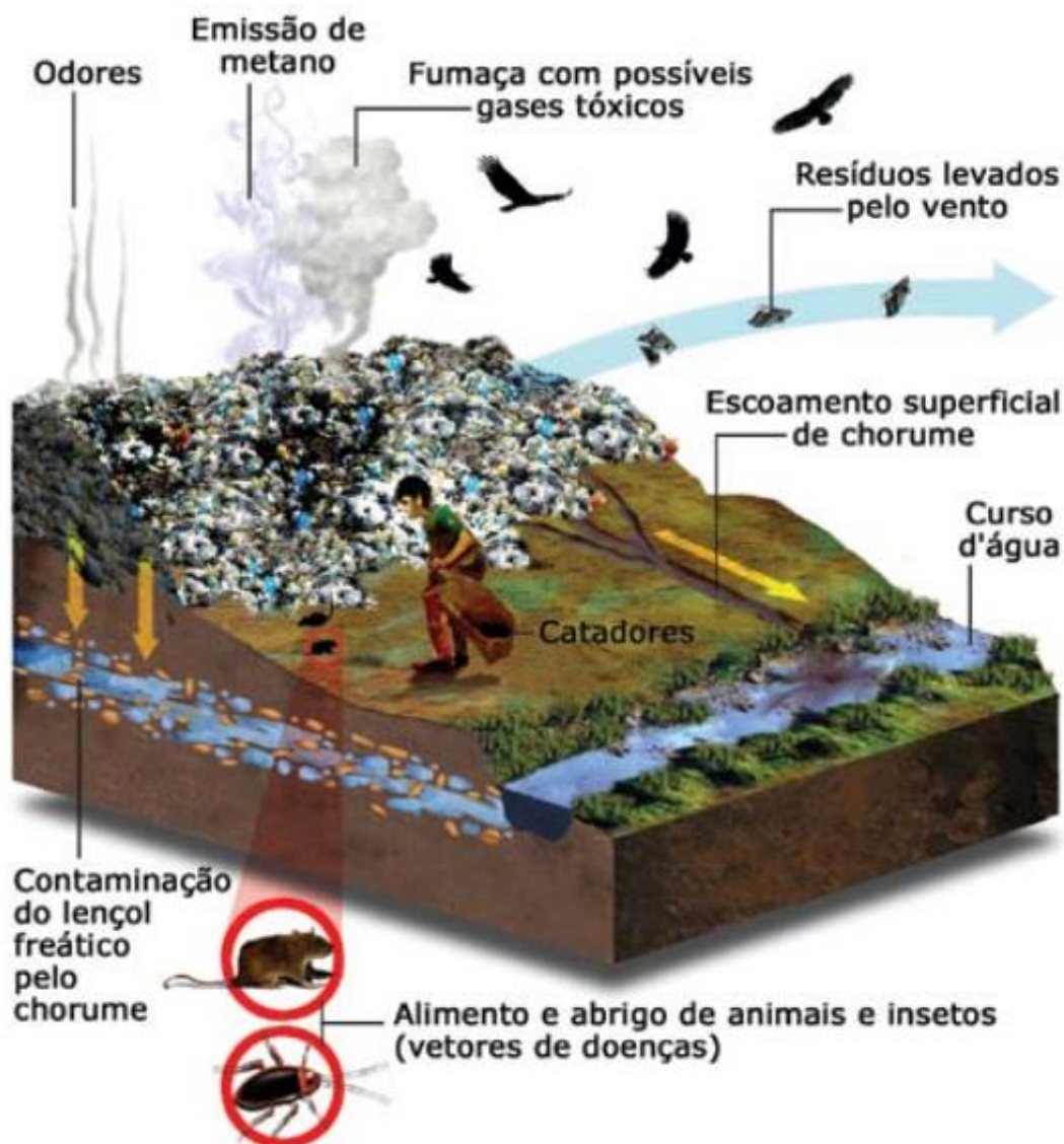
Figura 3 - Problemas relacionados à disposição inadequada de resíduos sólidos.
